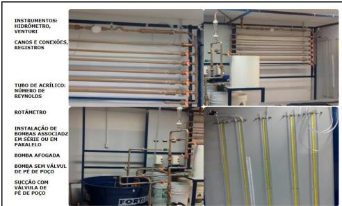
TANQUE SUPERIOR PARA SIMULAÇÃO DO SISTEMA DE BOMBIAMENTO DE EDIFÍCIOS COM AUTOMAÇÃO ELETRÔNICA
